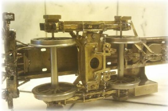
à toutes les nettoyer pour pouvoir les ré-assembler. Les pièces manquantes, sont faites dans des chutes de laiton.
