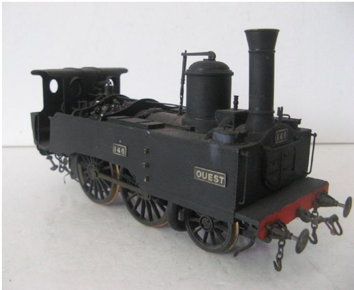
Ci-contre et ci-dessous, une machine provenant d'un kit Flèche d'or. Si le châssis est en laiton, la caisse est en résine
