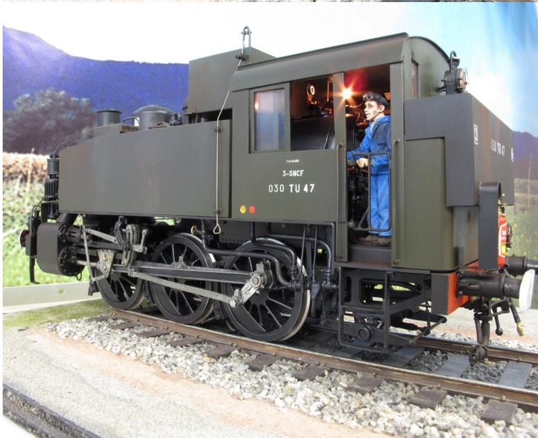
Elle est équipée d'un décodeur ESU XLV5. Celui-ci est placé en travers entre les caisses à eau (voir photo en bas à gauche). Ces nouveaux décodeurs possèdent une réserve d'énergie de 35 secondes environ et permettent un excellent ralenti grâce à de nombreux paramétrages du moteur. Fini les plantages ! Roues laiton, fumigène Seuthe, lanternes Kit Zéro.
