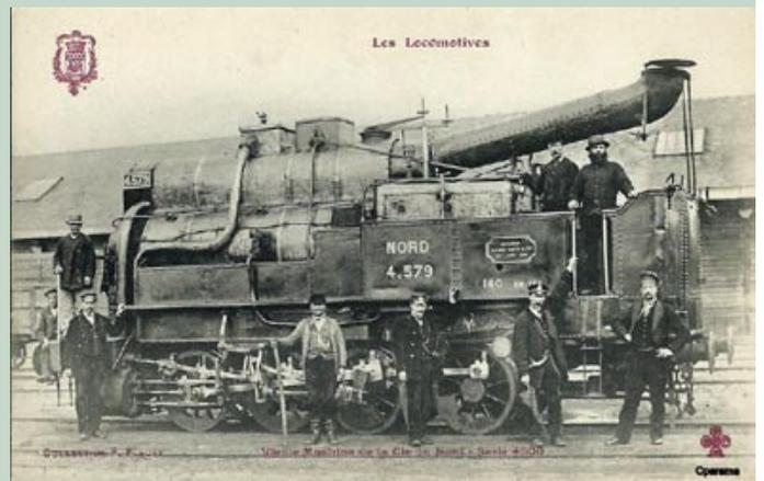
cheur de vapeur avec une cheminée tournée vers l'arrière. La surface de grille a été également augmentée (2,64 m<sup>2</sup>). Certaines machines n'avaient qu'un réservoir à vapeur avec cheminée classique. Les 4.606 à 4.631 furent construites en 1885/86, mais avec une chaudière «normale». En 1921, la série fut renumérotée 4.1750 à 4.1794.
