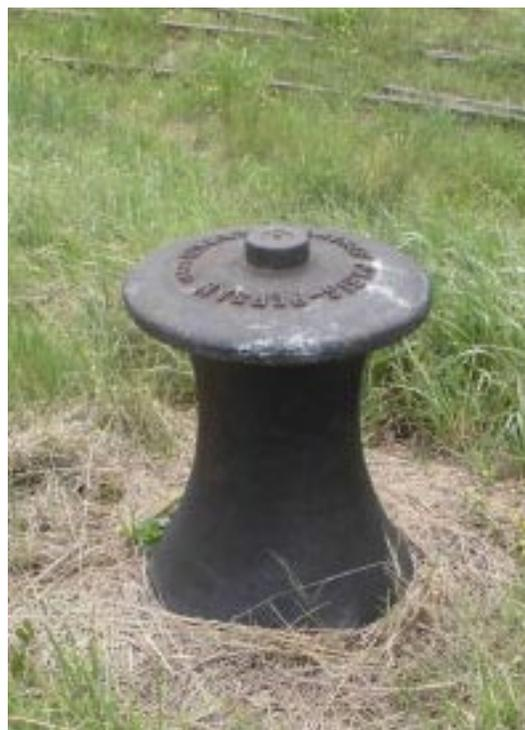
*Photos prises en été 2017 sur le CF de La Mure (poules de renvoi de 2 types différents, mais je n'ai pas trouvé trace d'un cabestan ou d'un treuil. Les manoeuvres étaient peut-être assurées avec un autre moyen de traction du câble, locomotive ou cheval ?
