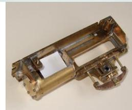
Le tender dispose de brancards en bois, réalisés sur le prototype avec du buis. La version suivante utilisera de l'olivier, bois tout aussi résistant mais dont les nervures sont plus marquées. Le frein est fonctionnel. Les caisses à outils sont ouvrantes. Les deux essieux sont suspendus et équipés de roulements à billes. Le couplage à la locomotive est réalisé à l'aide d'un clip qui assure également la connexion électrique.
