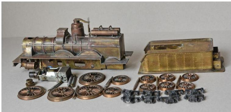
A droite et en bas: Le moteur FOURNEREAU (courant continu) est trop volumineux, il est placé sous le charbon et c'est le tender qui assure la propulsion.
